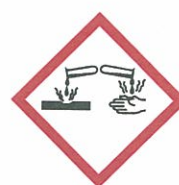
Жидкости, выливающиеся из двух пробирок и поражающие металл и руку
